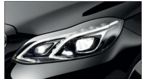
Bild: Voll-LED Scheinwerfer mit blendfreiem Fernlicht (Quelle: Hella KGaA Hueck & Co.)
